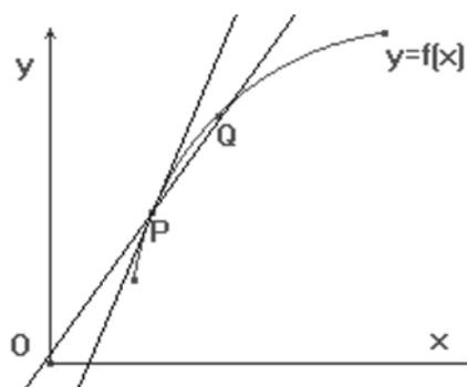
L'equazione della retta tangente alla curva di equazione  $y = f(x)$  nel punto P è  $y - y_0 = f'(x_0) \cdot (x - x_0)$  con  $P(x_0; y_0)$ .
